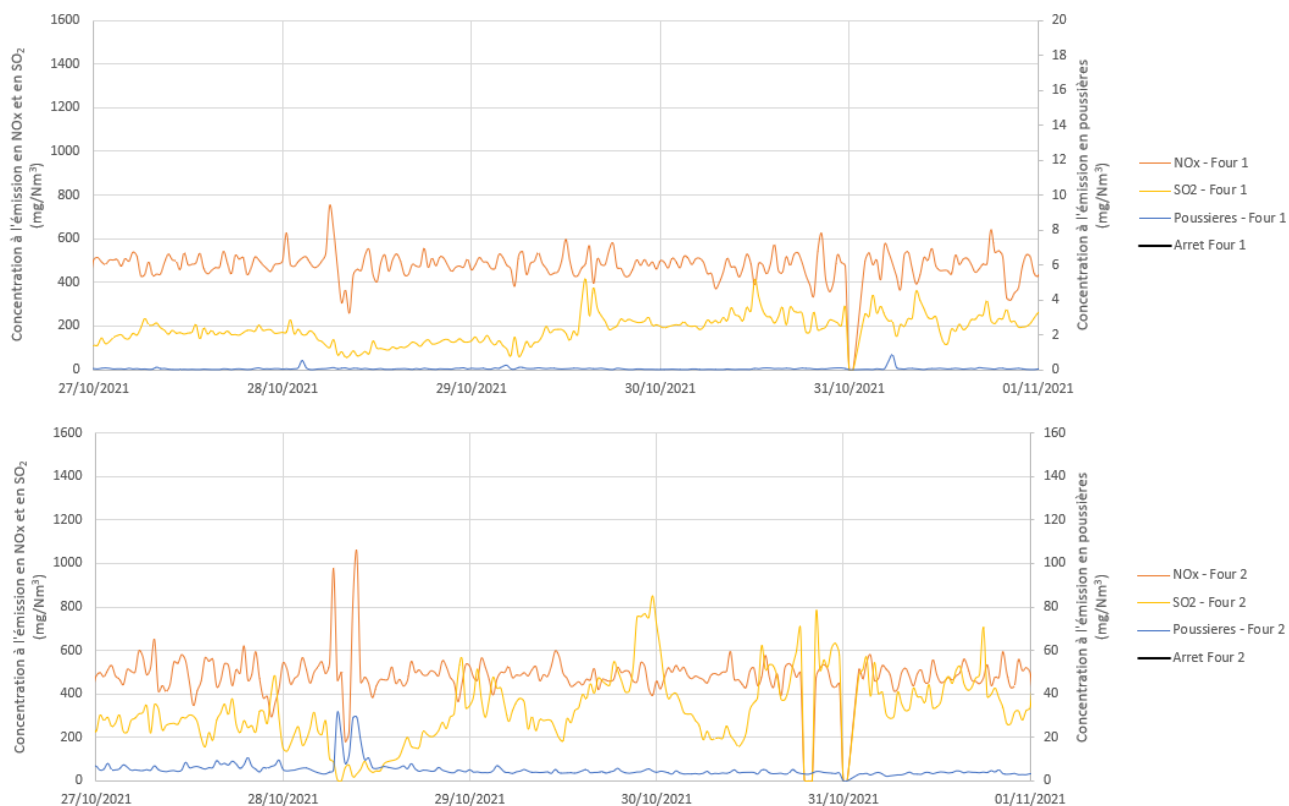
Figure 110 : Evolution des concentrations à l'émission des fours 1 et 2 entre le 27 et le 31 octobre
