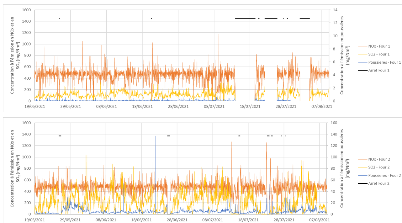
Figure 1 : Evolution des concentrations à l'émission pour les fours 1 et 2 et périodes d'arrêt – campagne Sousquières estivale
