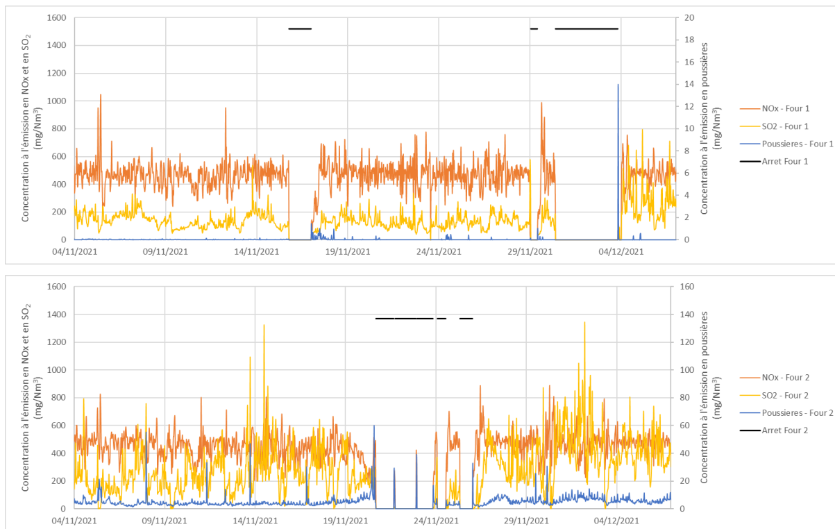
Figure 67 : Evolution des concentrations à l'émission pour les fours 1 et 2 et périodes d'arrêt – campagne Sousquières hivernale
