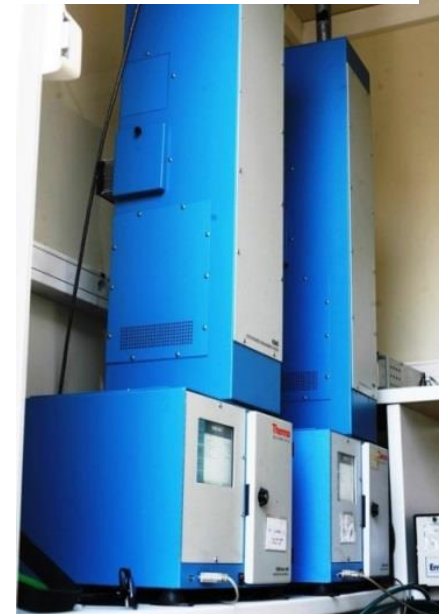
Mesures continues des particules fines
