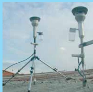
Têtes de prélèvement pour la mesure des particules en suspension dans l'air.
