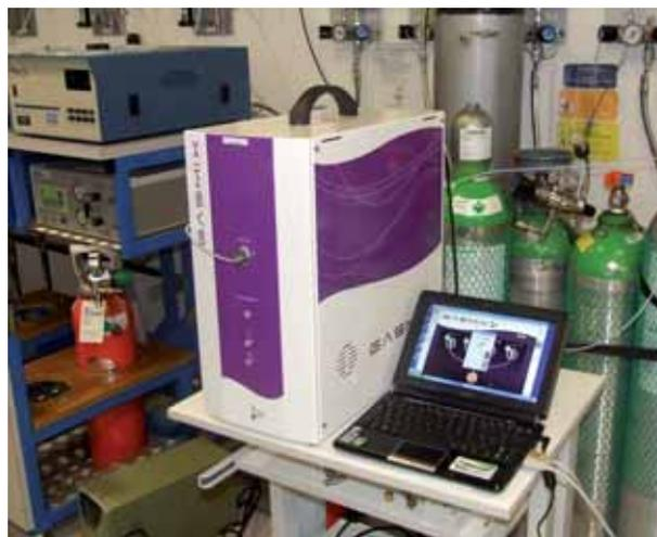
GasMix avec PC et interface de commande.
